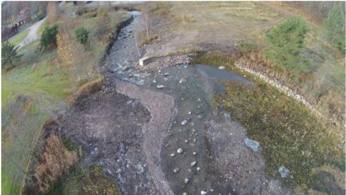
Figur 8. Sågdammen efter utrivning med bevarade dammvallar (Watermark Consulting AB, 2016).
